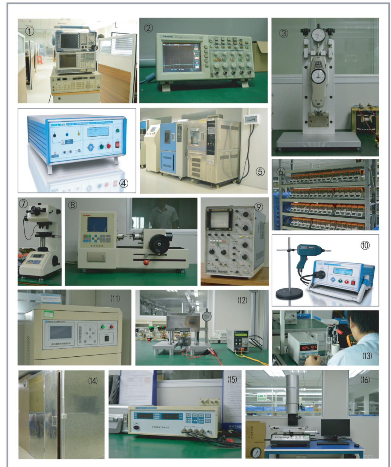
① 信号发生器 ② 示波器 ③ 推拉力计 ④ 晶体管特性图示仪 ⑤ 高低温试验箱
